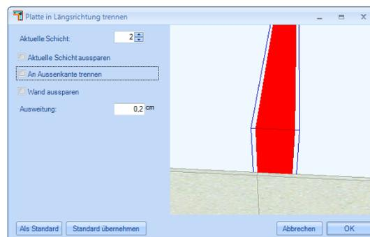
Ist kein Haken gesetzt, wird die Platte an der oben eingestellten Schicht getrennt
