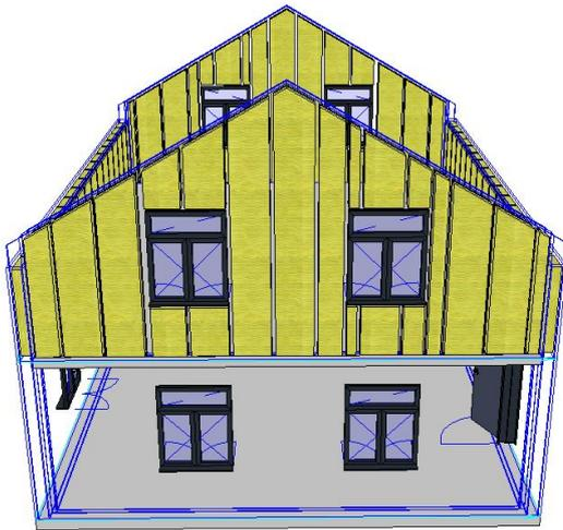
Bei dieser Funktion werden alle Wände in einem aktiven Stockwerk automatisch erkannt, und die freien Bereiche einer Ständerschicht wie im Bild links mit einer Dämmfläche ausgefüllt.
