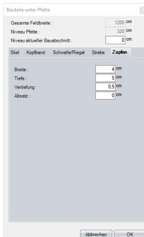
unter Zapfen können Sie einstellen wie Sie die Zapfenverbindung für die Stiele, Kopfbänder, Schwelle Riegel und Strebe erstellt bekommen möchten. Möchten Sie das für eine Bauteilart ein Zapfen erzeugt wird müssen sie jeweils unten den Hacken bei Zapfenverbindung erzeugen setzen.
