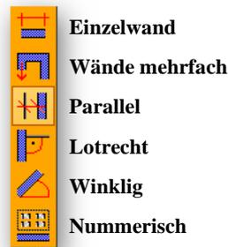
Wird der Haken bei *Massivwand erzeugen* entfernt, können auch direkt HRB-Wände (mehrschichtige Wände) erzeugt werden. Es kann der gewünschte Wandtyp ausgewählt und über die entsprechende Methode erzeugt werden.
