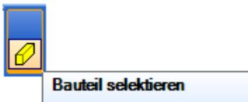
**Profilzeichnung mit Bauteilauswahl:** Es gibt bei der Profilzeichnung zusätzlich die Möglichkeit, Bauteile auszuwählen, die in der Profilzeichnung angezeigt und vermaßt werden. Dazu wählen Sie nach Auswahl der Dachfläche die Option *Bauteil selektieren* und klicken die gewünschten Bauteile an. Die Bauteile lassen sich auch über Mehrfach- sowie Bereichsauswahl selektieren. Sind alle Bauteile selektiert, wird durch Drücken der Leertaste die Zeichnung erstellt.
