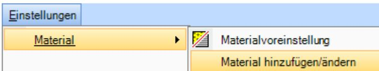
Mit der Funktion Material anlegen / ändern könne neue Materialien angelegt oder geändert werden. Neuangelegte oder geänderte Materialien werden erst nach einem Neustart des Programms übernommen.
